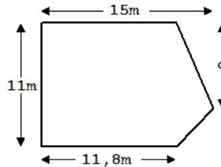
$$\begin{aligned} 147,4 &= 15 \cdot 11 \\ &- (3,2 \cdot c) : 2 - \\ &- (3,2 \cdot (11 - c)) : 2 \\ c &= 7,6 \text{ m} \end{aligned}$$
